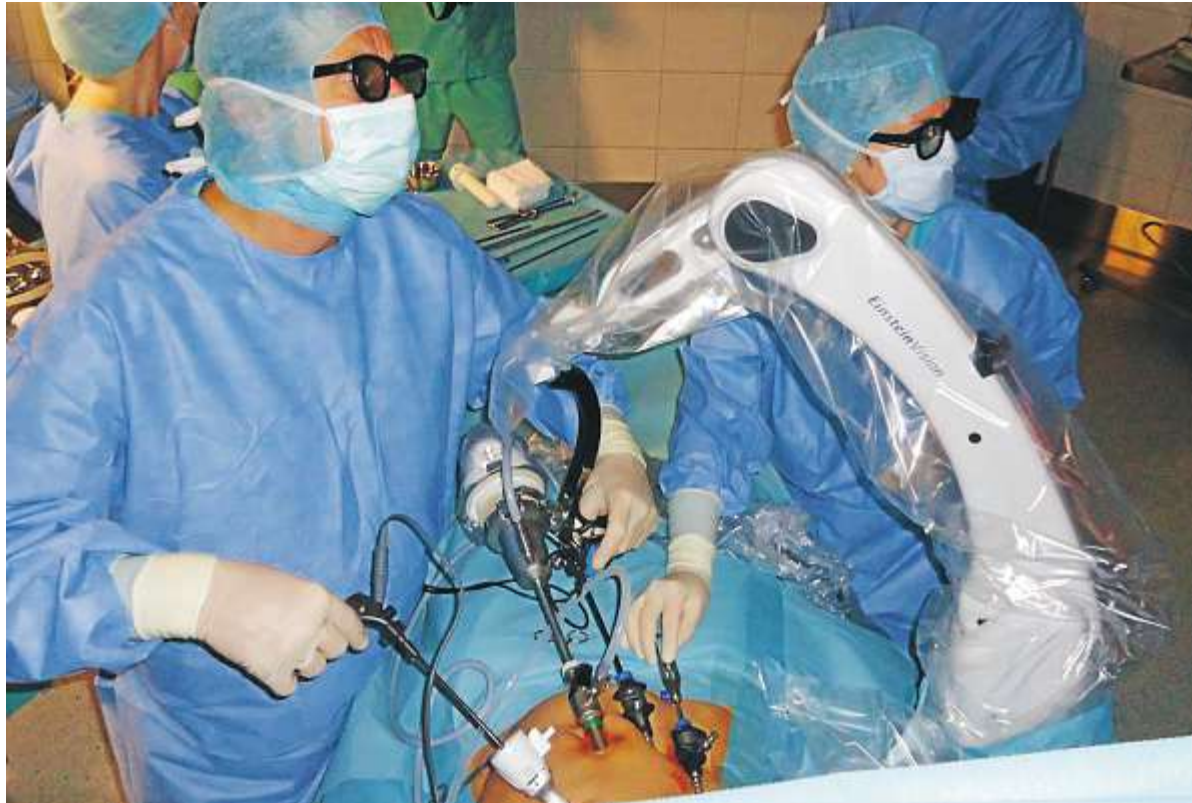
Schlüsselloch-Operation mit dem „Soloassist“: Eine Art Roboterarm führt die Kamera, der Assistent ist frei für anspruchsvollere Tätigkeiten oder bei kleineren Operationen gar nicht mehr vonnöten. Foto: AKTORmed
